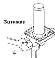
1. Перед монтажом клапана трубопроводы должны быть прочищены, т.к. попадание
